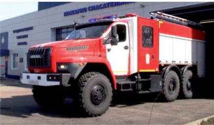
пожара боевой расчет, пожарно-техническое вооружение и запас огнетушащих веществ. В автомобиль вмещаются до 6 человек, запас воды - 6000 литров, пенообразователя - 300 литров. В комплектацию автоцистерны входит специальная одежда пожарных, носилки для пострадавших, покрывало для оказания первой медицинской помощи, гидравлический аварийно-спасательный инструмент.
